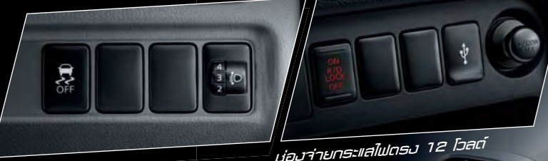
ปุ่มปรับระดับไฟฟ้า 4 ระดับ บ่อนจ่ายกระแสไฟตรง 12 โวลต์
