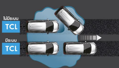
TRACTION CONTROL SYSTEM (TCL) ระบบป้องกันล้อหมุนฟรี และควบคุมการลื่นไถล ระบบจะช่วยควบคุมการหมุนของล้ออย่างสมดุล ในสภาวะถนนลื่น เพื่อไม่ให้รถสูญเสียการยึดเกาะถนน
