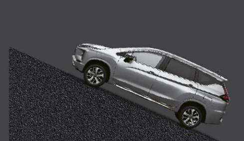
HILL START ASSIST (HSA) ระบบช่วยออกตัวบนทางลาดชัน ช่วยป้องกันรถไหลเมื่อต้องออกตัวบนทางลาดชัน
