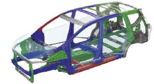
High Tensile Strength Steel ■ 980 MPa class ■ 590 MPa class ■ 440 MPa class
