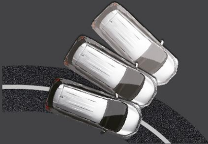
ACTIVE STABILITY CONTROL (ASC) ระบบควบคุมเสถียรภาพการทรงตัว ในสภาวะที่รถเสียสมดุล เพื่อช่วยควบคุมกรณีที่เกิดการสั่นโคลงออกนอกเส้นทาง เช่น กรณีหลุดโค้งเมื่อเข้าโค้งด้วยความเร็วสูง ถนนลื่น หรือหักหลบกระทันหัน
